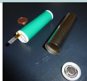
Analyse de construction - cellule Li-ion
