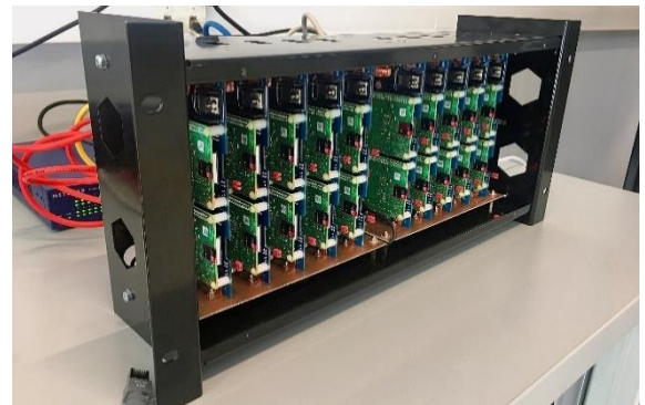
Contrôleurs de réseaux multi-terminaux (DC Grid Control, relais de protection)
