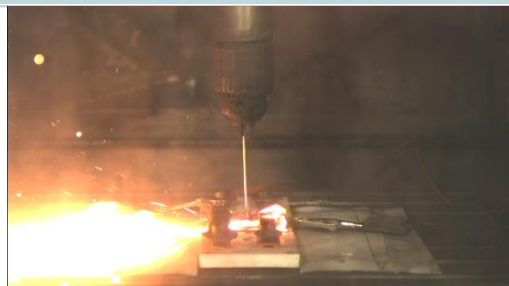
Test au clou - cellule Li-ion
