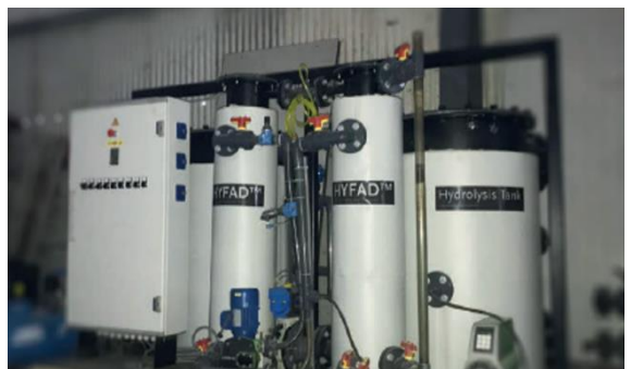
PILOTE DE 2x 250L : tests à l'échelle pilote
