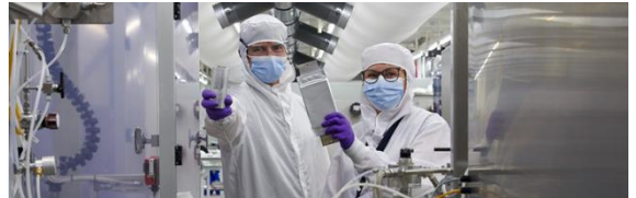
Salle anhydre dédiée à la fabrication des batteries Li-ion
