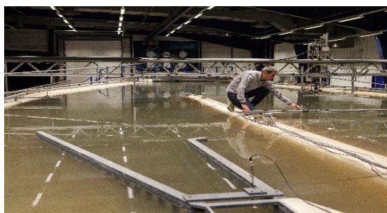
Modèle physique centrale hydroélectrique
