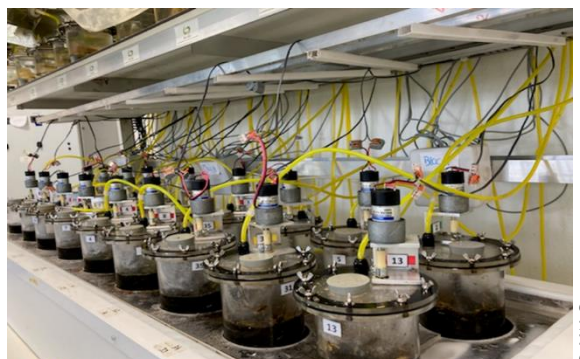
Réacteurs de 2 et 5L : tests à l'échelle laboratoire
