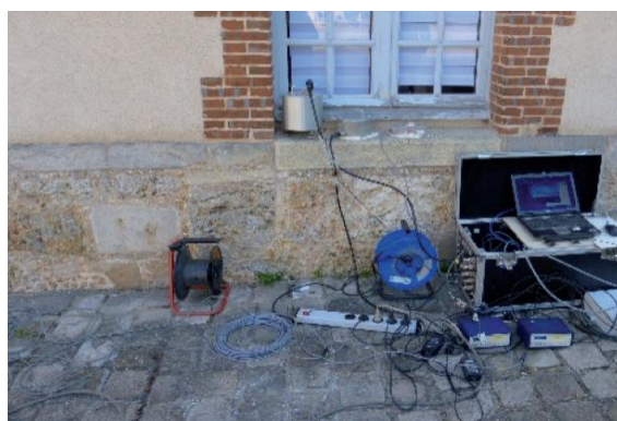
Mesures croisées vitesse-accelération Château des Mesnuls (78)
