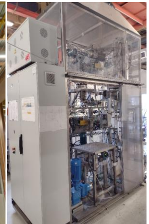
Réacteur gazéification en eau super critique GASEAU
