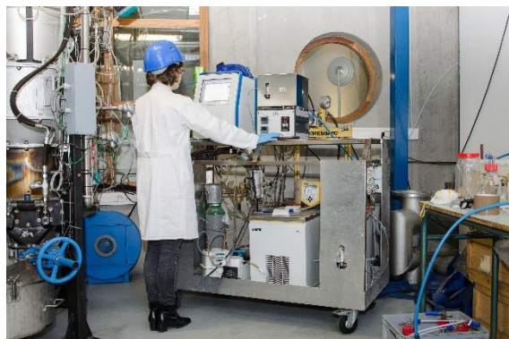
Banc d'analyse en ligne du syngaz
