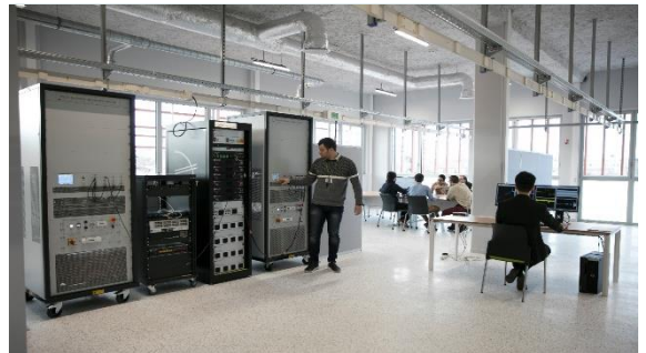
PHIL setup (maquette MMC, amplificateurs de puissance et cible temps-réel)
