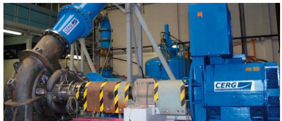
BEEP : Boucle d'Etudes et d'Essais de Pompes
