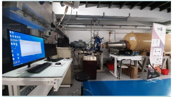
Station de pilotage STEP DUO Francis et bulbe sur microgrid DC
